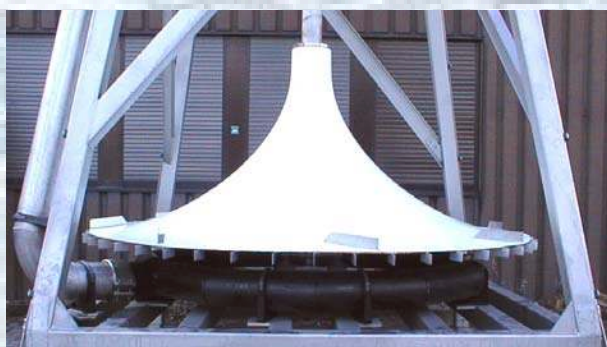
Фиг. 7: HYPERCLASSIC®-аерационна система като т.н. "кафезен" вариант. Тук става въпрос за монтаж на аерационна кула в пълен басейн, която има всички части: HYPERCLASSIC® бъркалка, аерационен пръстен, поддържаща конструкция, въздухопровод (евент. може и въздуходувката да се монтира на кулата). Тази форма на комплектна инсталация е от особена полза при налични басейни, които се нуждаят от допълнително приспособление за разбъркване и аерация, без да трябва да се изпразва басейнът.
